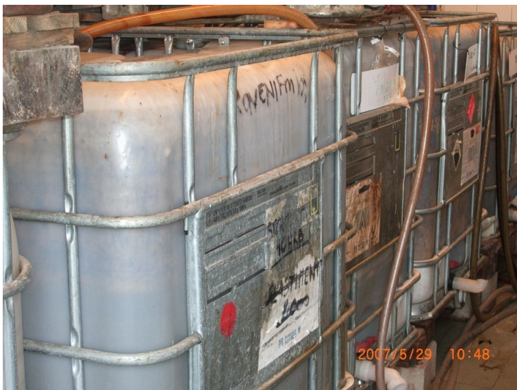
2. ábra: Adalékszertároló konténer a Holcim Hungária Zrt. Kőbányai Betongyárában
