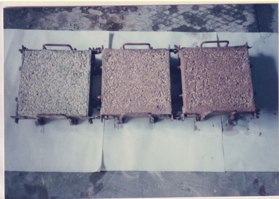
16. fénykép. Vas-oxid porral szinezett, kimosott felületű beton próbatestek
